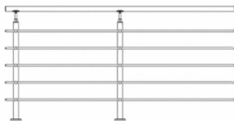
Une fois les fixations installées, vous devez procéder au positionnement des supports pour les tubes de remplissage sur les poteaux.
